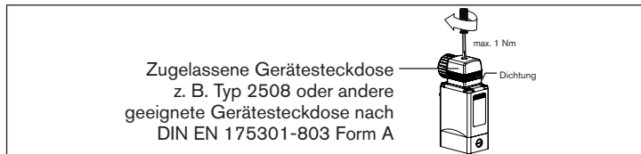
Bild 3: Elektrischer Anschluss der Gerätesteckdose
